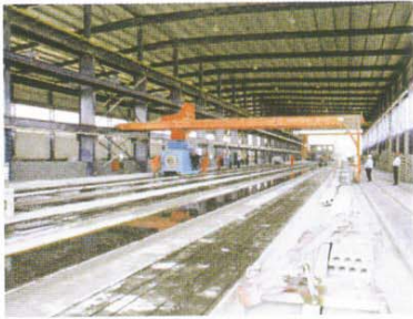
Production takes place in two halls, arranged in parallel, each fitted with seven prestressing beds of approx. 140 m production length. Die Herstellung erfolgt in zwei nebeneinander liegenden Hallen mit je sieben Spannbetten à rund 140 m Produktionslänge.
