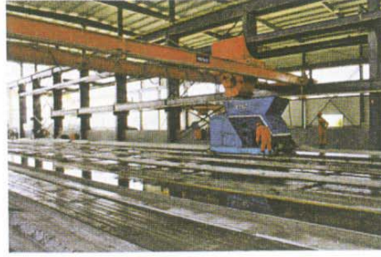
Production takes place in two halls, arranged in parallel, each fitted with seven prestressing beds of approx. 140 m production length. Die Herstellung erfolgt in zwei nebeneinander liegenden Hallen mit je sieben Spannbetten à rund 140 m Produktionslänge.
