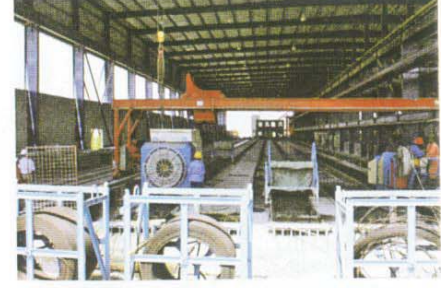
Production takes place in two halls, arranged in parallel, each fitted with seven prestressing beds of approx. 140 m production length. Die Herstellung erfolgt in zwei nebeneinander liegenden Hallen mit je sieben Spannbetten à rund 140 m Produktionslänge.
